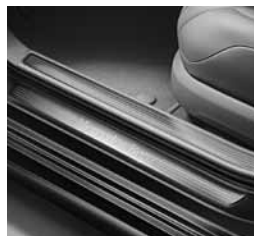
Vstopni pragovi iz nerjavnega jekla spredaj in zadaj, spredaj z napisom Mercedes-Benz
