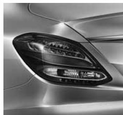
Zadnje luči, vključno zavorna luč in zadnja meglenka s tehnologijo LED
