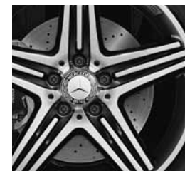
Perforirani zavorni koloti spredaj
