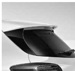
Radijska antena integrirana v strešni spojler
