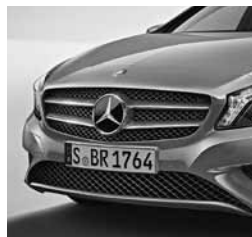
Maska hladilnika z dvojnimi lamelami v barvi vozila in kromiranimi vstavki
